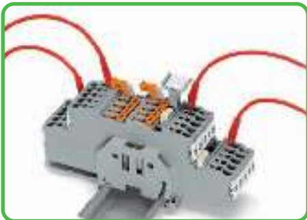
Групповой маркировочный держатель располагается в разьеме контакта перемычки
