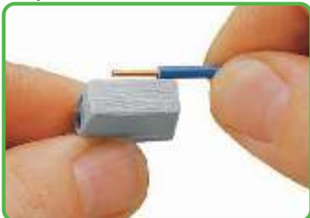
Изоляцию проводника снять на длине 9 - 11 мм
