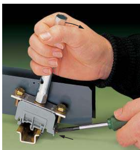
Демонтаж с DIN-рельса 35 мм
