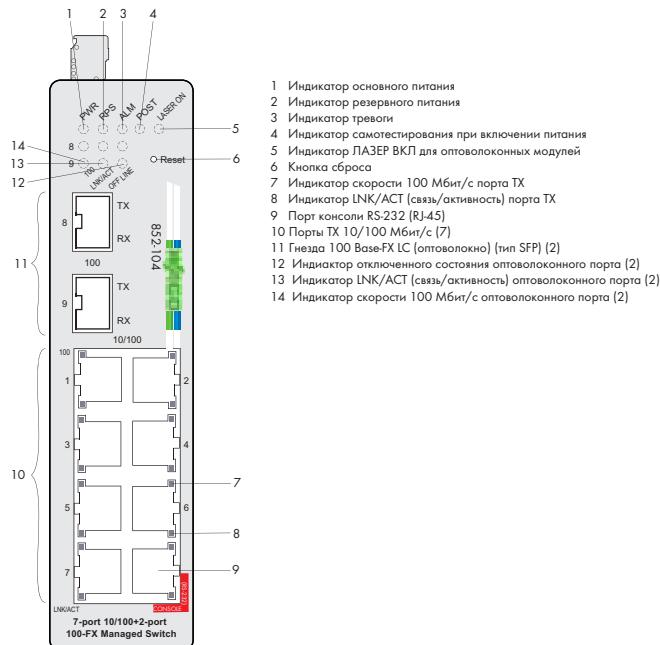
Промышленный коммутатор 852-104 представляет собой конфигурируемый коммутатор ETHERNET с 7 портами 10/100Base-TX и сдвоенным портом SFP 100Base-FX (модули SFP являются опциональными).
